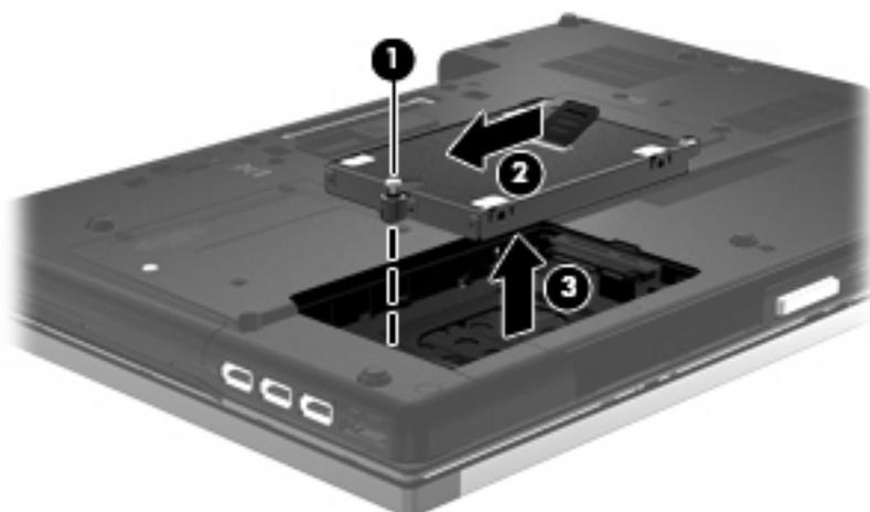
Для установки жесткого диска выполните следующие действия.
